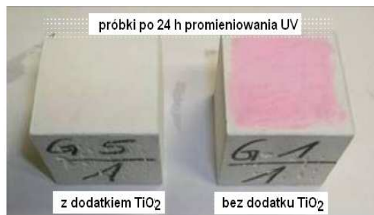
Fot. 1. Właściwości fotokatalityczne cementu TioCem – test efektywności fotokatalitycznej z zastosowaniem rodaminy-B i promieniowania UV
